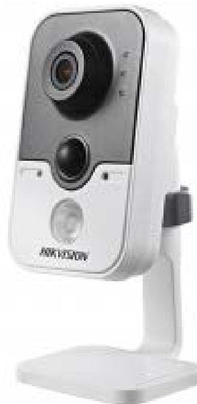
Светодиодный индикатор на лицевой стороне камеры
